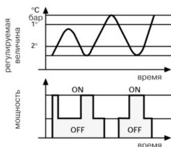
Все модели горелок серии **RGD** имеют двухступенчатую регулировку мощности. Переход с одной ступени на другую осуществляется посредством изменения давления подачи топливного насоса. Модель **RG5D** имеет две форсунки, по одной для каждой ступени, которые работают при одном и том же давлении на топливном насосе.
